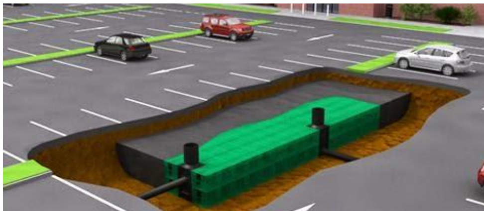
Gambar 4. 8 Tangki air hujan di bawah tempat parkir, untuk meresapkan air ke dalam tanah atau menampungnya untuk pemanfaatan operasional taman.
