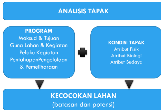
Gambar 2.3 Analisis Tapak merupakan sebuah proses penilaian kesesuaian tapak dengan kegiatan baru yang akan dialokasikan di dalamnya.
