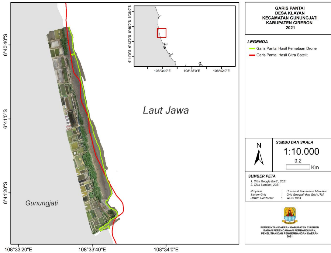
Gambar 4.9 Perbandingan garis pantai di pesisir Gunungjati
