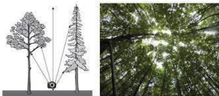
Gambar 3.10 Ilustrasi metode hemispherical photography (Korhonen et. al., 2008) (kiri), Hasil pemotretan dengan lensa fisheye secara vertikal (kanan)
