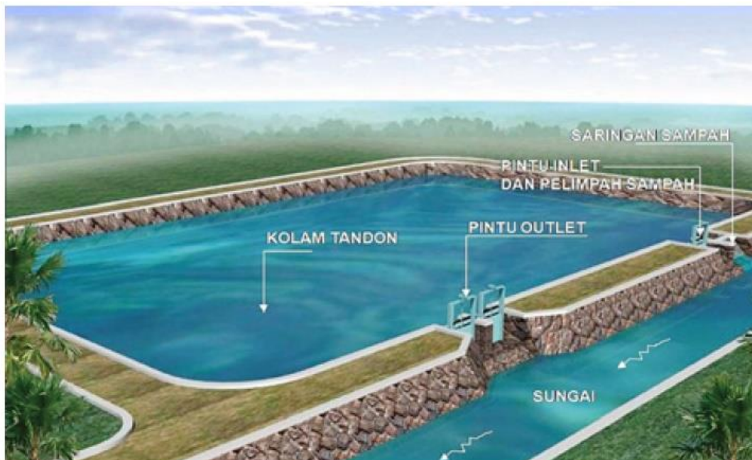
Gambar 5.68. Kolam detensi dan retensi yang terletak di samping badan saluran/sungai
