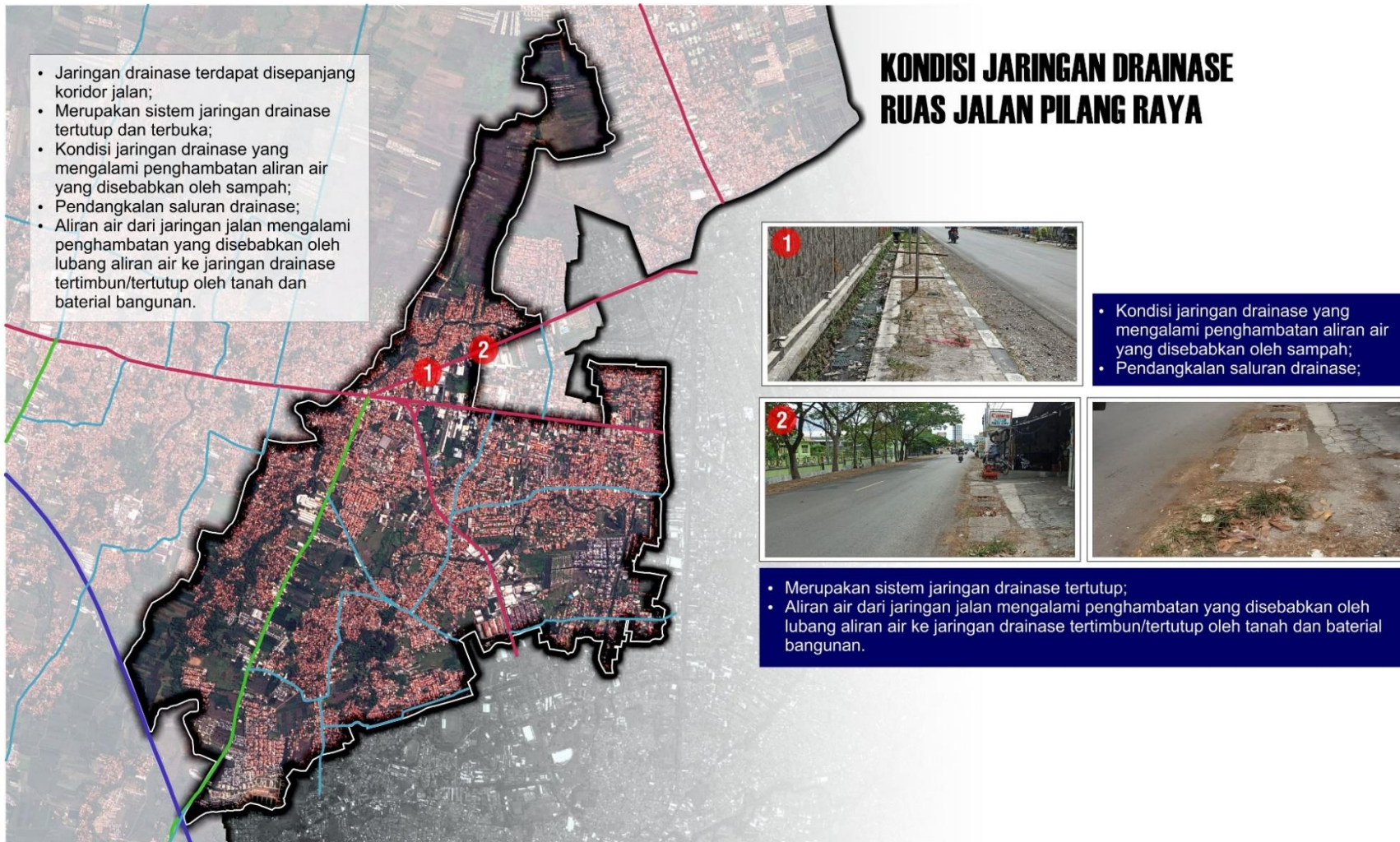
Gambar 4.17 Kondisi Sistem Jaringan Drainase Ruas Jalan Pilang Raya
