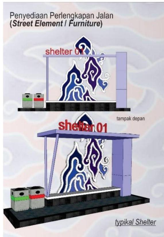
Gambar 5.44. Desain Tipikal Shelter / Halte Angkutan Umum
