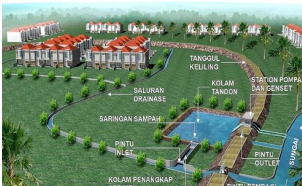
Gambar 5.70. sistem polder dengan instalasi pompa
