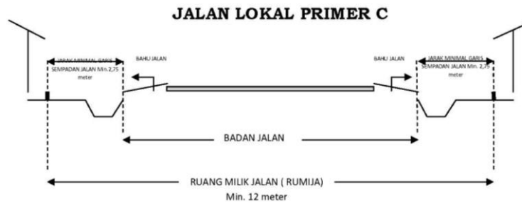
Gambar 4.11 Ilustrasi Ketentuan Garis Sempadan Jalan Lokal di Wilayah Kabupaten Cirebon Berdasarkan Peraturan Daerah Kabupaten Cirebon Nomor 11 Tahun 2012 tentang Garis Sempadan
